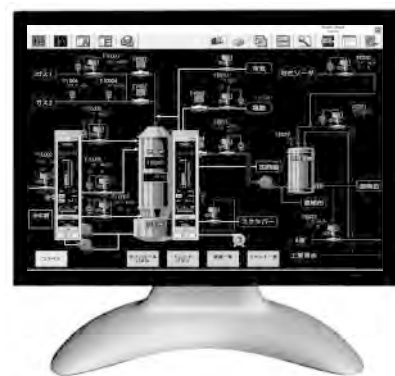
モニタツールとGT SoftGOT1000を組み合わせたパソコン監視システム
