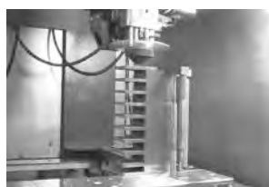
図2. 高板厚領域での断線点挿入による結線
