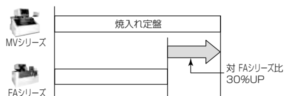
図8. MVシリーズの定盤硬度比較
