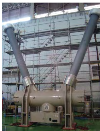
800kVガス遮断器
