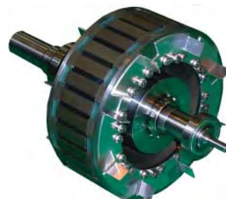
試作したレアアースレスモータの回転子
