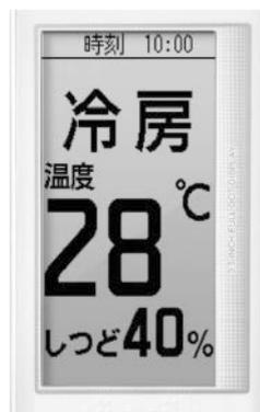
図2. 運転内容と温度・湿度が大きく表示される簡易表示画面
