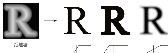
図1. 距離場を用いた文字描画処理
