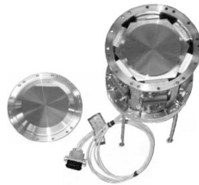
図7. ヒートスイッチの試作モデル
