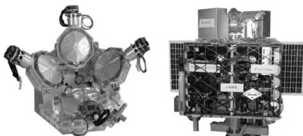
図3. 小型CMG試作機と地上衛星シミュレータ
