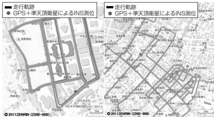
(a) 新宿のINS複合測位 (b) 銀座のINS複合測位
