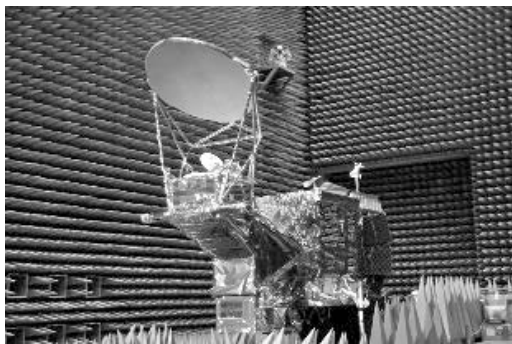
図4. 衛星システム試験中のAMSR2(JAXA提供)
