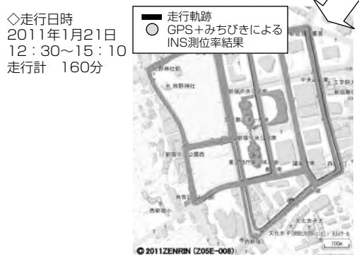
(c) 新宿のGPS+みちびきによるINS測位 (測位率100.0%)
