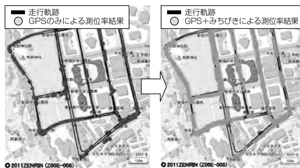
(a) 新宿のGPSのみによる測位 (測位率28.5%) (b) 新宿のGPS+みちびきによる測位 (測位率70.0%)
