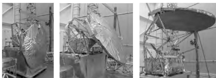
図 3. サブシステム試験(展開試験)中のAMSR2
