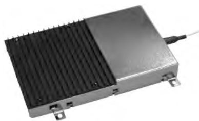
図3. デュアルレートOLT光トランシーバの外観
