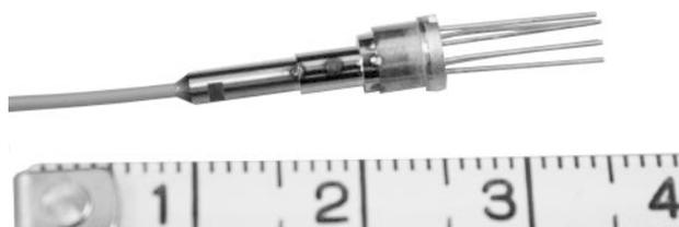
図7. 同軸型PDモジュールの外観
