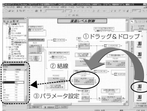
図2. プログラミングツールの操作例
