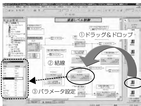
図2. プログラミングツールの操作例
