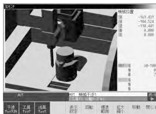
図2. 機械動作シミュレーション(機械衝突防止機能)
