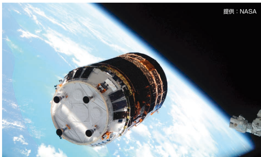
ISSの窓から見えるHTV実証機(ISSへのランデブに成功、相対停止し、ISSのロボットアーム(右下)で把持される場所)
