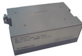
メッシュミドルウェアを実装したスマートメータ内通信端末
