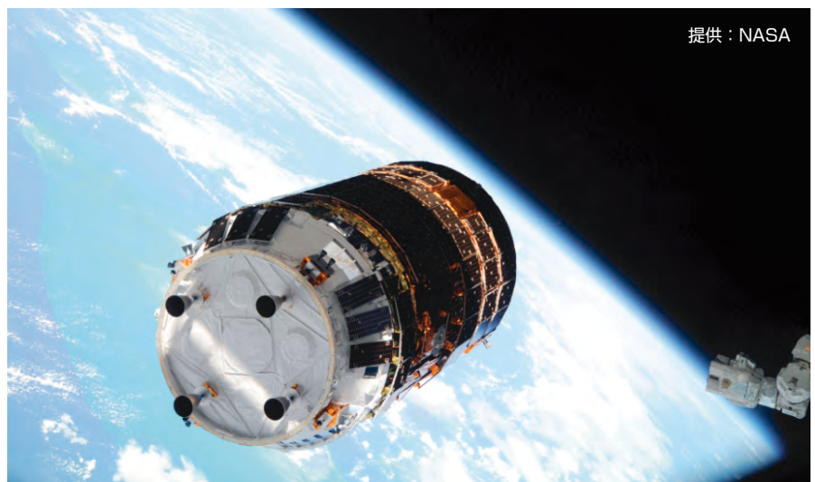
ISSの窓から見えるHTV実証機(ISSへのランデブに成功、相対停止し、ISSのロボットアーム(右下)で把持される所)
