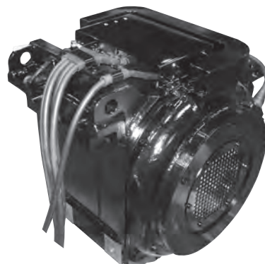
寒冷地向け全閉形主電動機
