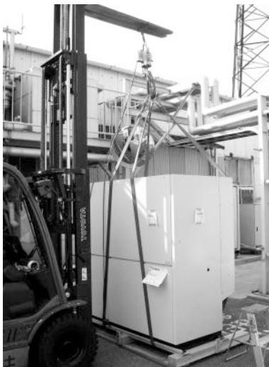
図1. 実機評価試験(落下試験)
