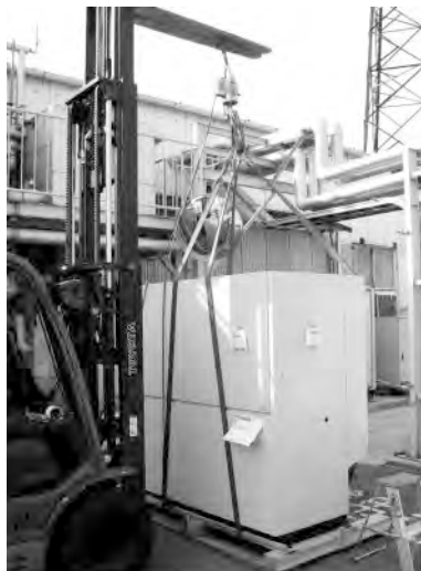
図1. 実機評価試験(落下試験)
