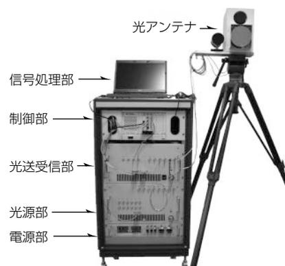
図7. CO<sub>2</sub>濃度計測DIALの地上検証モデル
