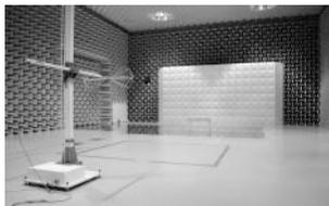
図5. EMC大型電波暗室
