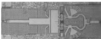
図 9. C~Ku帯広帯域高出力増幅器
