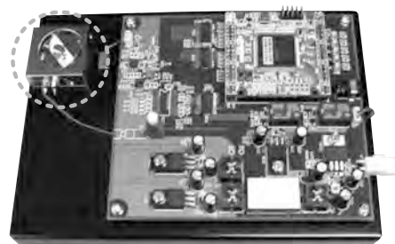
図 6. 端末用小型傾斜ビームアンテナ装置
