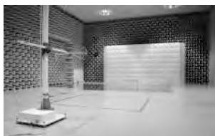
図5. EMC大型電波暗室
