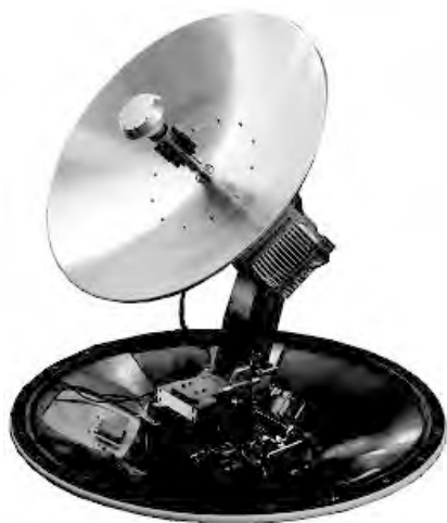
Ku帯ブロードバンド船舶衛星通信端末
