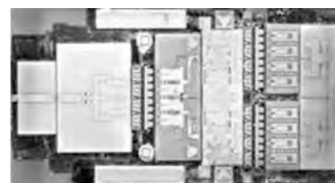
図 7. X 帯広帯域高出力増幅器
