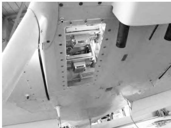
図5. 機上局アンテナの航空機機体底部への設置状態
