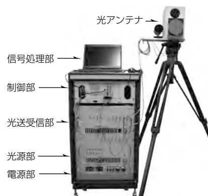
図7. CO 2 濃度計測DIALの地上検証モデル
