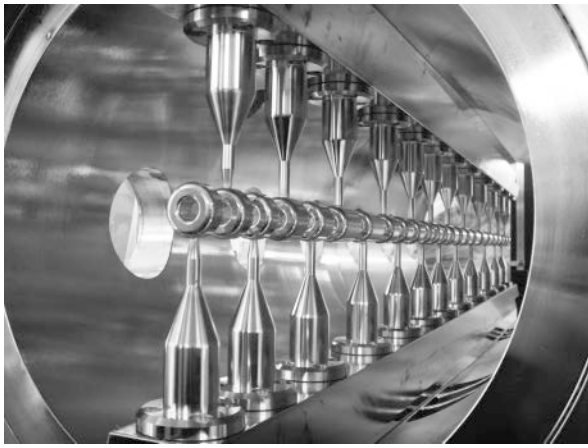
図3. APF方式IH型DTL内部
