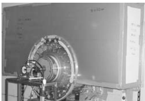
図11. 縮小モデルの風洞試験装置
