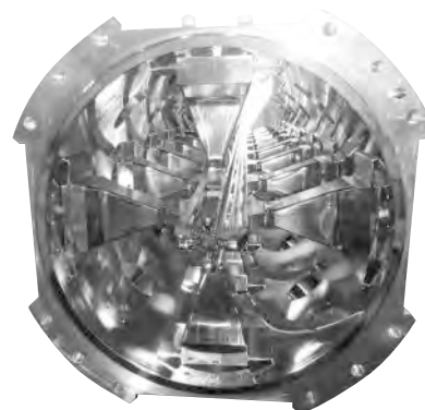
図2. RFQ型線形加速器内部
