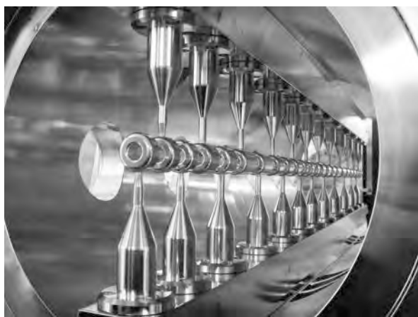
図 3. APF方式IH型DTL内部
