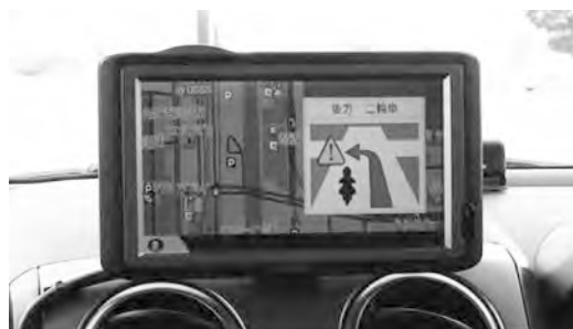
図6. 注意喚起画面の例(左折時衝突防止支援システム)
