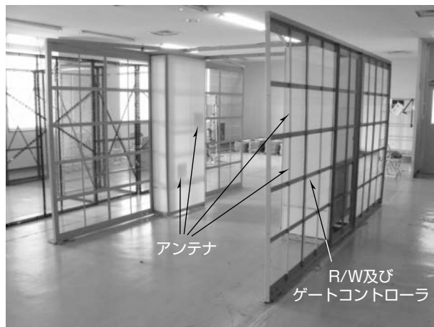
図8. 試作ゲートの外観
