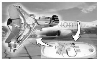
図5. 航空機搭載アンテナ
