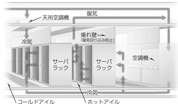
図1. 冷却システム構成例
