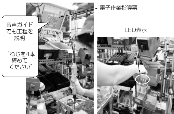
図3. 業務用プリンター組立工程のデジタル屋台
