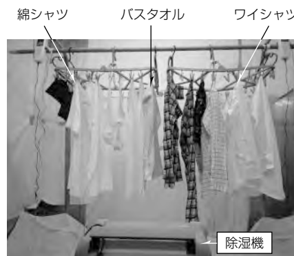
図6. 衣類乾燥試験状況(実用衣類2kg)
