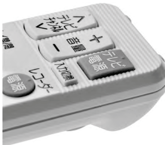
図1. 凹凸溝によるTV操作部のゾーニング
