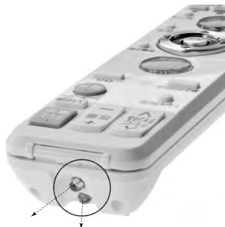
図7. 角度を変えて配置した二つの赤外線送信部
