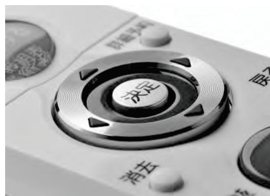
図6. 触覚で識別できる4方向ボタン
