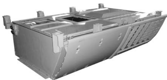
前位空調装置
