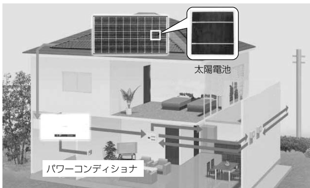
図1. 太陽光発電システム
