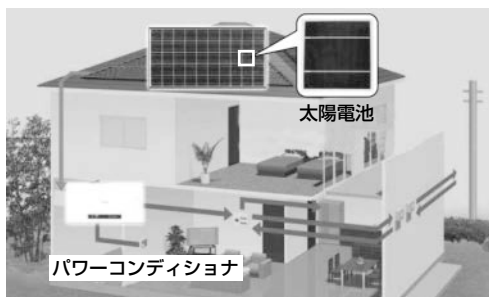
太陽光発電システム
