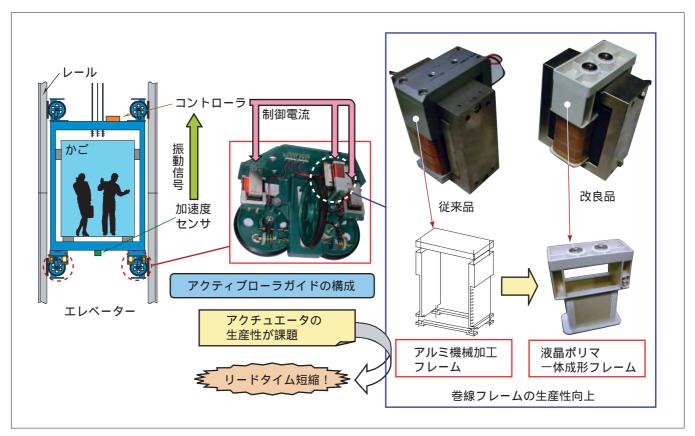
アクティブローラガイドの構成とアクチュエータ巻線フレーム樹脂化による生産性の向上
