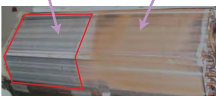
汚染試験後の熱交換器
