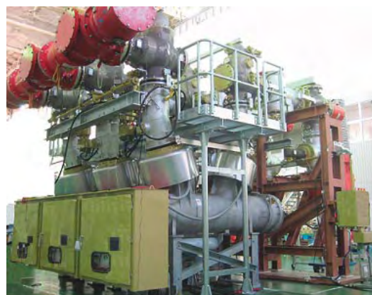
245kV 80kA GIS
