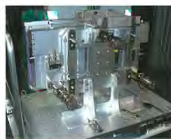
図2. 5軸超高分解能駆動機構 (50nm駆動精度)
