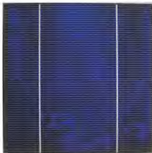
図1. 世界最高効率のハニカムテクスチャー多結晶シリコン太陽電池セル
