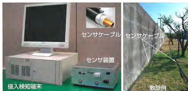
センサ装置・侵入検知端末・センサケーブルの外観と敷設例
