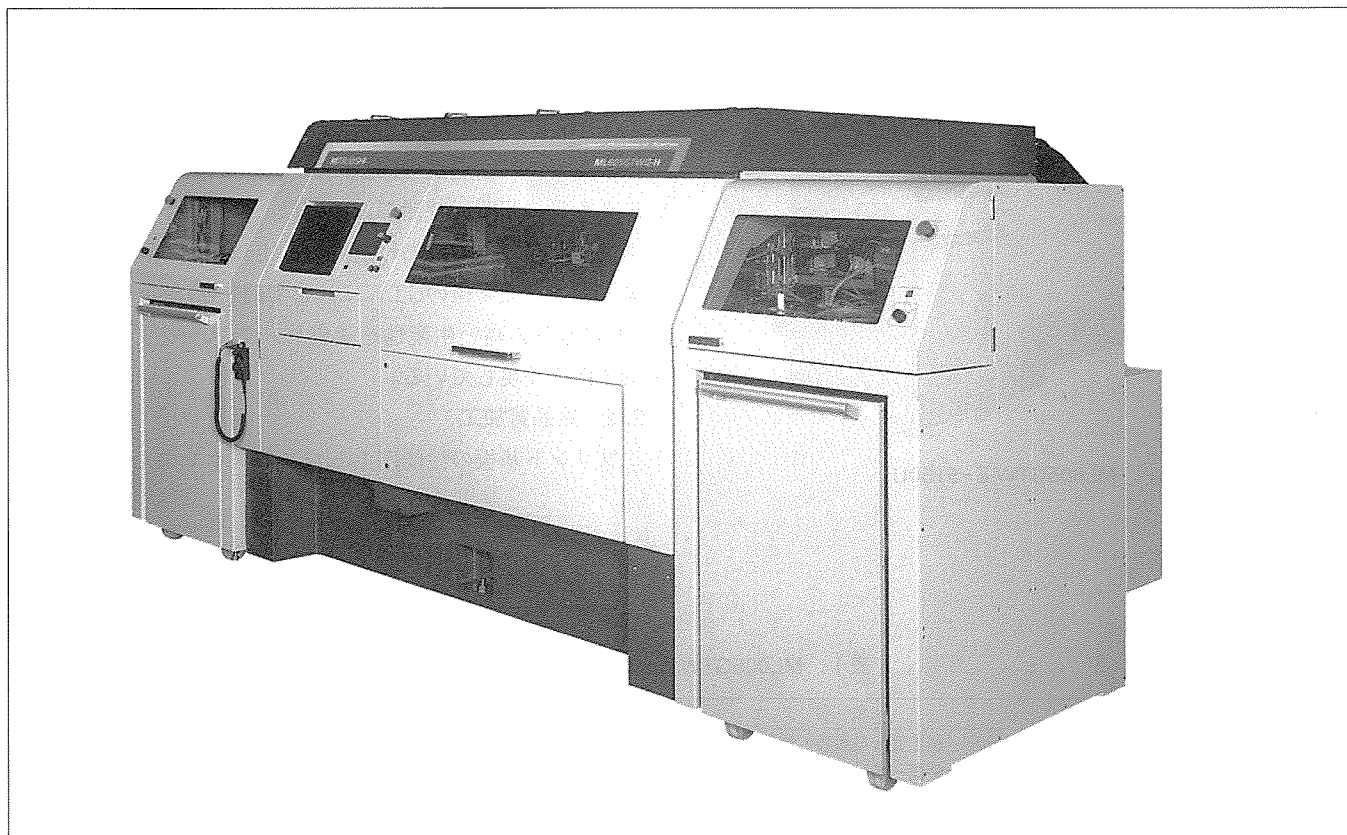
プリント基板穴あけ用レーザ加工機 “ML605GTW II -5150U”
