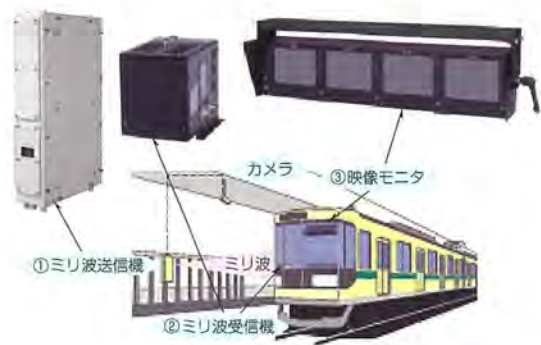
図1. ホーム画像伝送装置(40GHz帯免許波、アナログ伝送)
