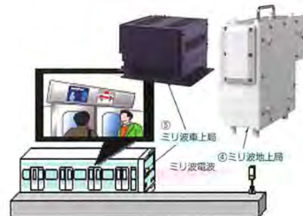
図2. コンテンツ伝送装置 (60GHz帯特定小電力無線局、デジタル伝送)
