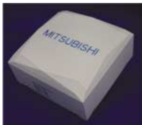
サイズ: 11 x 11 x 4.5(cm) 小型アンテナ試作機
