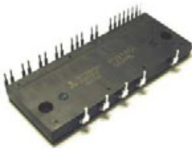
トランスファーモールド形 小容量パワーモジュール (20A/600V DIP-IPM)
