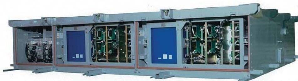
強制循環式水冷主変換装置の外観
