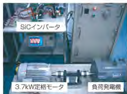
図1. SiC-MOSFET インバータによる 3.7kW 定格モータ駆動の様子
