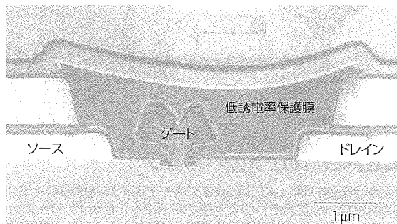
図3. MGF4934AMの断面構造
