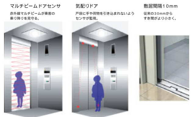
図3 . ユニバーサルドアシステム
