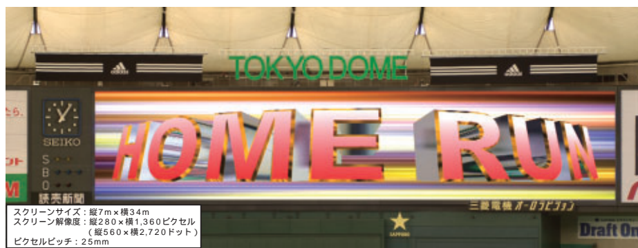
東京ドームフルカラー一体型スクリーン(サイズ:縦7m×横34m)
