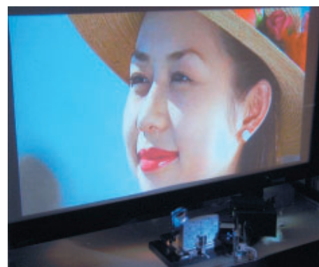
超広角光学エンジン試作機によるフロント投写 (62インチ画面)
