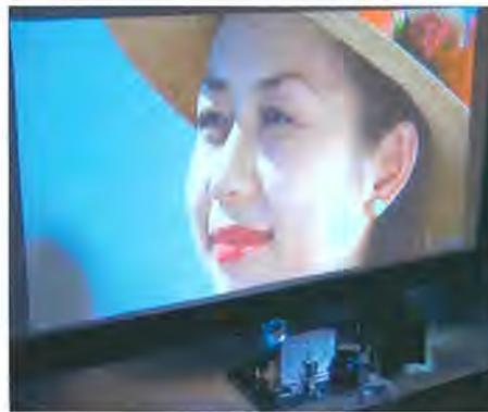
超広角光学エンジン試作機によるフロント投写
