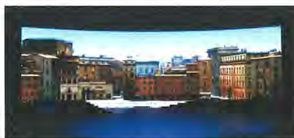
図1. コロシウム(ラスベガス)納入の屋内型スクリーン (長さ33.28mm, 高さ10.24m, ピクセルピッチ16mm)
