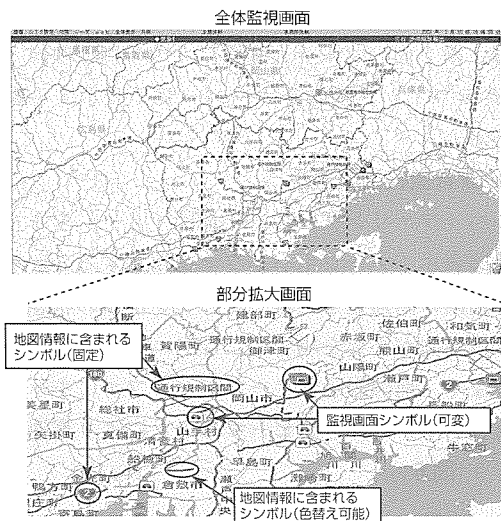
図9. 道路広域映像監視システムの画面例
